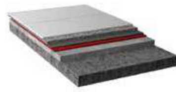
Dry laying on gravel Colocación en seco sobre grava
